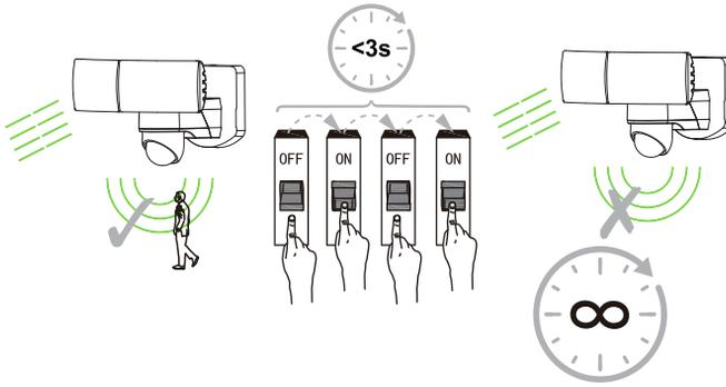
**Activate sensor override mode** Aktivieren Sie den Sensor-Override-Modus/Activer le mode prioritaire du capteur
